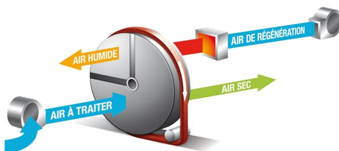
Les déshydrateurs **DESSICA** utilisent deux flux d'air indépendants qui traversent la roue déshydratante à contre-courant, mis en mouvement par deux ventilateurs. Cette roue, composée de silicagel, un matériau capable de retenir la vapeur d'eau contenue dans l'air, tourne lentement. En traversant la roue, l'air à traiter perd son humidité retenue par le silicagel. L'air sec est ensuite directement utilisable.
